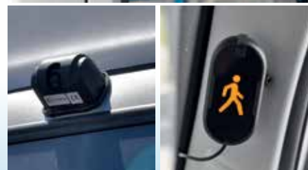
BOČNA I PREDNJA KAMERA za nadzor prostora s desne strane i ispred vozila, aktiviraju upozorenje u kabini
