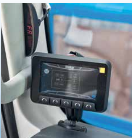
U LIJEVI NOSAČ KROVA je zaslon sustava asistencije, a pored njega je i vizualizacija parkirnih senzora, koji imaju i zvučno upozorenje
