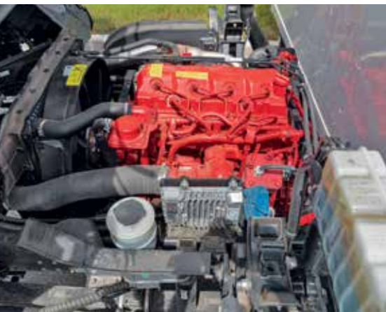
4-CILINDRIČNI CUMMINS motor obujma 3,8 litara razvija 122 kW (163 KS) i 584 Nm okretnog momenta
