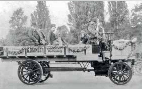
1898. je predstavljen model nosivosti 5 tona, s motorom sprijeda i prijenosom s pomoću kardanskog vratila
