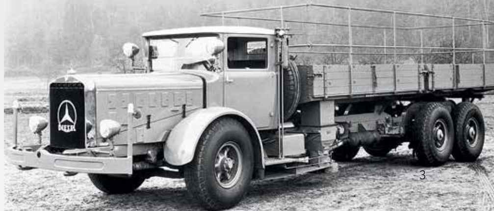
LK 10000 iz 1937. bio je jedan od najvećih kamiona svoga vremena - dužina 10 m, nosivost od 10 tona, motor obujma 12,5 litara sa 150 KS te pogon 6x4
