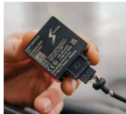
DSRC MODUL omogućuje brzu provjeru tahografskih podataka bez zaustavljanja vozila
