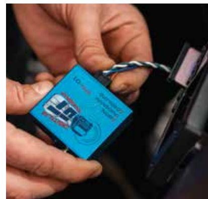
DTD - DIGITAL TACHOGRAPH DOWNLOAD – uređaj za daljinsko očitavanje podataka s tahografa, koji postaje obavezan i za laka gospodarska vozila u međunarodnom prijevozu
