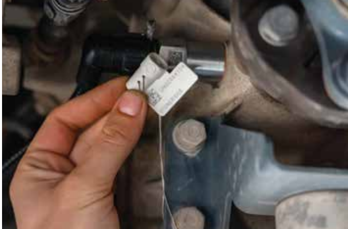
UGRADNJA I PLOMBIRANJE SENZORA ključni su za pouzdan rad tahografa i sprječavanje manipulacija podacima
