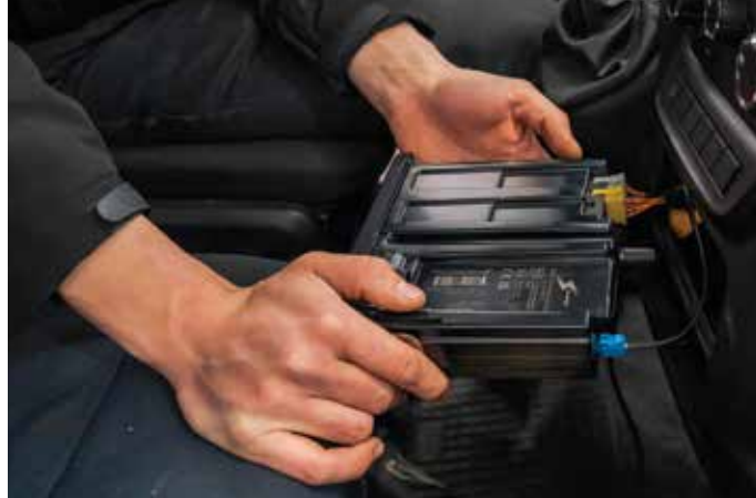
ISPRAVNO POVEZIVANJE NAPAJANJA i GNSS antene osigurava kontinuiran rad tahografa i precizno praćenje lokacije
