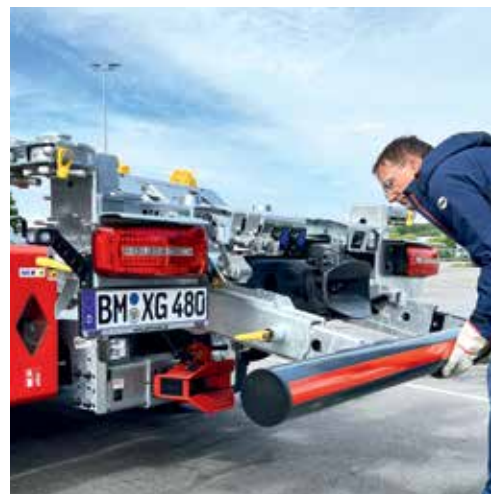
PLINSKE OPRUGE olakšavaju četverosmjerno podešavanje stražnje zaštite od podlijetanja osobnih vozila
