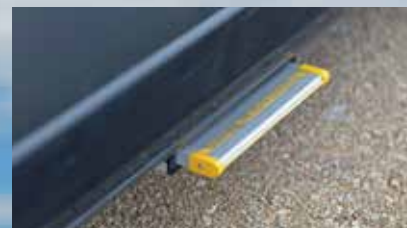
ULAZNA STEPENICA koja se izvlači prilikom otvaranja bočnih kliznih vrata
