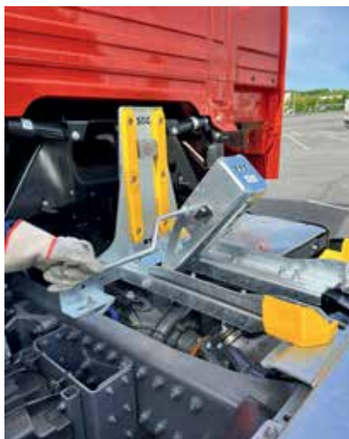
PODESIVI GRANIČNIK iza kabine osigurava precizno pozicioniranje kontejnera različitih dimenzija
