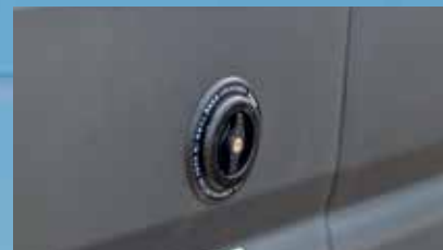
ZAKON NALAŽE UGRADNJU SKLOPKE za otvaranje izvana u slučaju nužde
