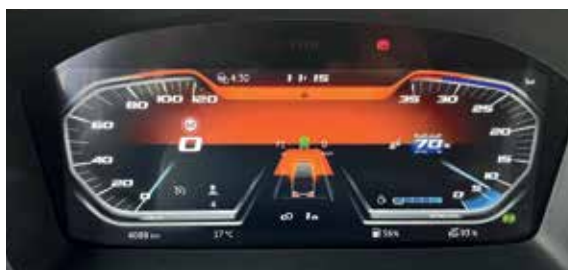
OSIM SUVREMENOG DOJMA digitalni instrumenti u novom kućnom stilu pružaju više informacija uključujući one koje zahtijeva GSR 2
