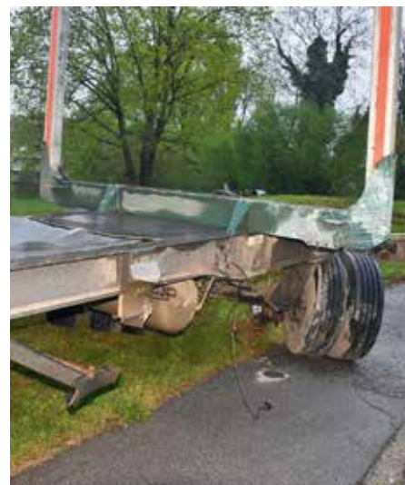
ZBOG RELATIVNO VISOKE ŠASIJE , udarac u automobil bio je u visini poklopca motora
