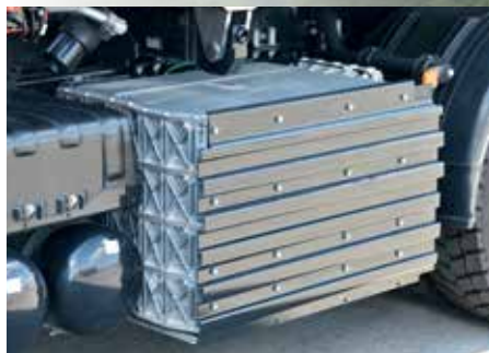
BATERIJSKI MODUL ima kapacitet od 80 kWh (89 kWh bruto) i težinu od 630 kg
