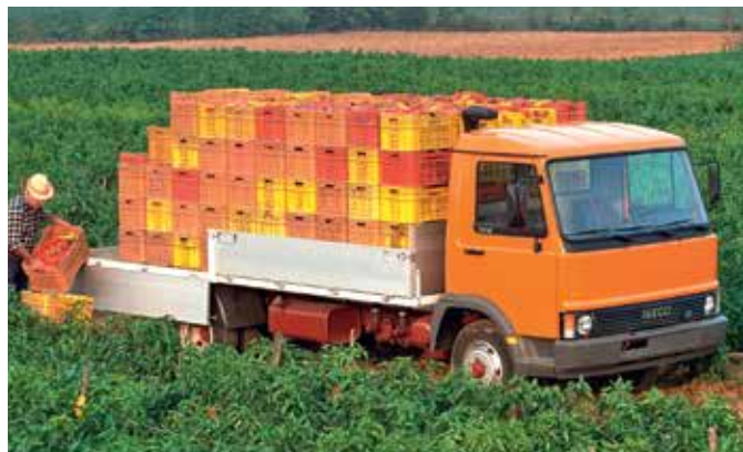
IVECO 330.30 je 1986. sa zračno hlađenim Deutz V8 motorom od 306 KS i kao i s vodenom hlađenim Iveco R6 turbo motorom od 304 KS. Serija "Z" je 1987. dobila novi izgled i nazive Zeta ili TurboZeta, ovisno o motoru
