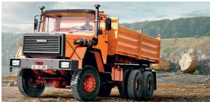
IVECO 330.30 je 1986. sa zračno hlađenim Deutz V8 motorom od 306 KS i kao i s vodenom hlađenim Iveco R6 turbo motorom od 304 KS. Serija "Z" je 1987. dobila novi izgled i nazive Zeta ili TurboZeta, ovisno o motoru
