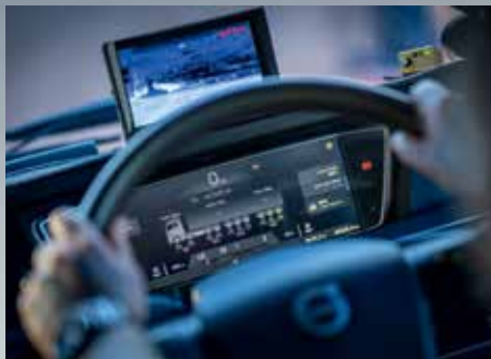
EKRAN S PRIKAZOM INFRACRVENE KAMERE koja po noći otkriva životinje na cesti
