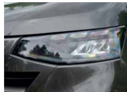
LED DNEVNA I GLAVNA SVJETLA su u seriji, baš kao i "Light Assist" kontrola dugog svjetla
