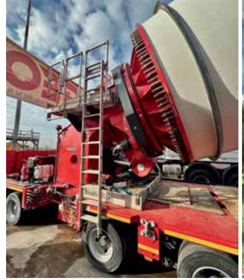
PRILAGOĐENO PRIČVRŠČIVANJE ELISE vjetroelektrane za prikolicu u praktično samo jednoj (donjoj) točki
